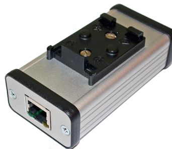
Sprejemnik v ohišju za DIN letev
